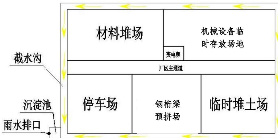
图 2.4-9 施工营地平面布置示意图
